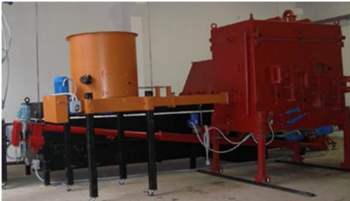
Impianto Pirodistilgasogeno per lo sfruttamento di biomasse con produzione di SYNGAS
